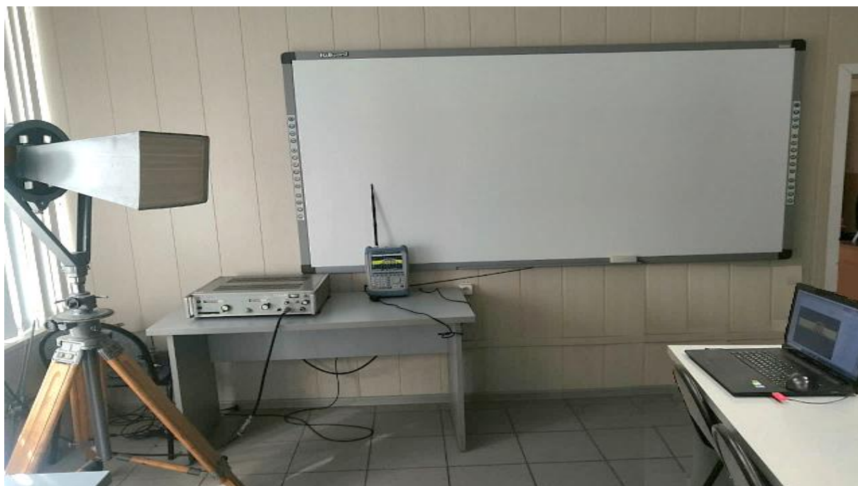
Рис. 4. Фото экспериментальной установки по воспроизведению ДЭМВ при использовании в качестве источника ДЭМВ генератора Г4-83
